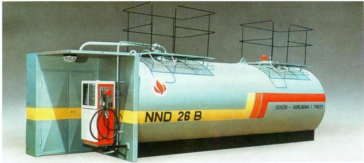
NND 10B, NND 16B, NND 26B, NND 32B sú nadzemné dvojplášťové nádrže s kompletným strojným a elektrickým vybavením pre stáčanie, skladovanie a výdaj pohonných hmôr ( motorová nafta a automobilový benzín). Nádrže sú jednokomorové s jednou strojovňou, jedným stáčacím čerpadlom a jedným výdajným stojanom. Určené sú pre jeden druh pohonných hmôr. Výkon výdajného stojana podľa typu 50 až 100 dm<sup>3</sup>/min.
