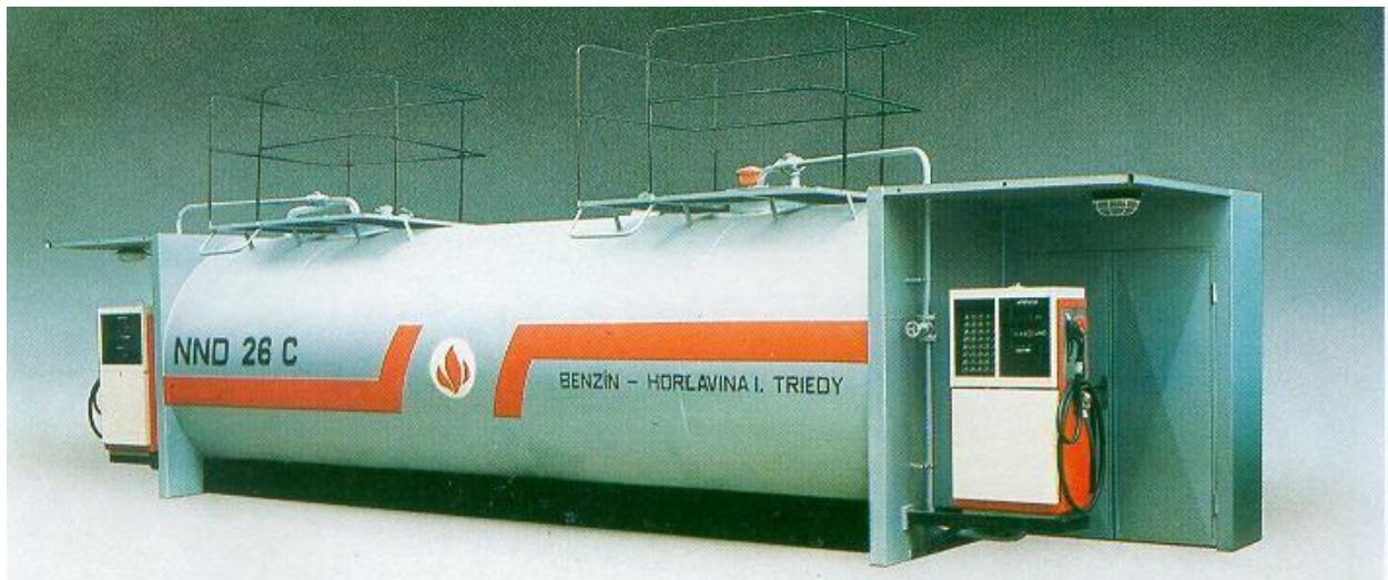
NND 10C, NND 16C, NND 26C, NND 32C sú nadzemné dvojplášťové nádrže s kompletným strojním a elektrickým vybavením pre stáčanie, skladovanie a výdaj pohonných hmôt. Nádrže sú jednokomorové so strojovňou na jednej strane nádrže. Druhá strojovňa slúži ako sklad olejov a pomôcok pre motoristov. Určené sú pre jeden druh pohonných hmôt. Výdaj zabezpečujú dva výdajné stojany s výkonom 50 až 100 dm<sup>3</sup>/min, ktoré umožňujú súčasné plnenie dvoch automobilov.
