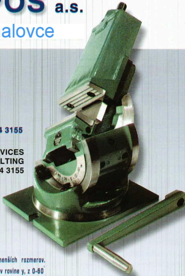
Zveráky sú určené na upínanie obrobkov menších rozmerov. Umožňujú otáčanie o  $360^\circ$  okolo osi z, sklopanie v rovine y, z  $0-60^\circ$  a sklopanie v rovine x, z  $\pm 45^\circ$ .
